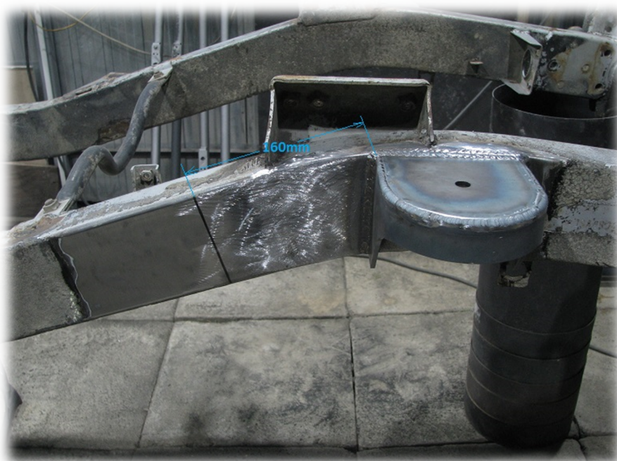
Fot.9 Widok przedniej prawej podłużnicy ramy, wyznaczanie środka górnego mocowania amortyzatora
