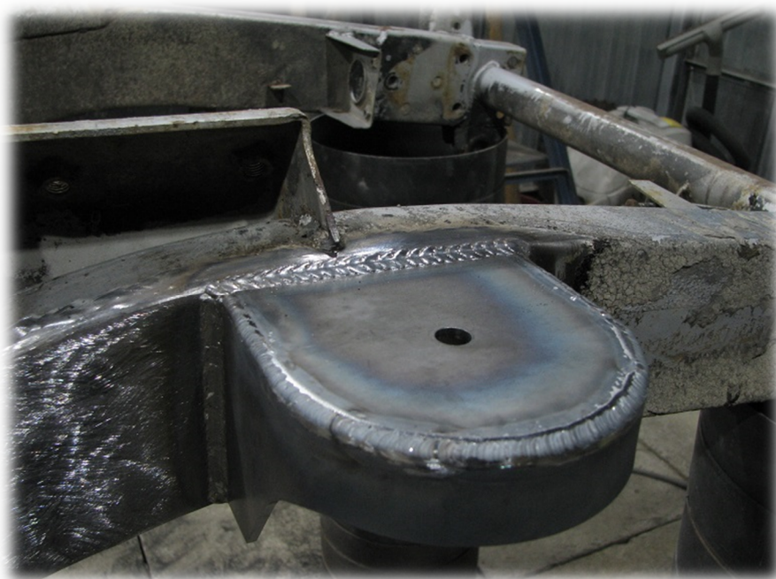
Fot.7 Połączenie spawane górnego gniazda sprężyny
