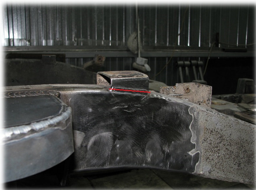
Fot. 13 Korekta podpory podłogi dla uzyskania płaskiej powierzchni boku ramy.
