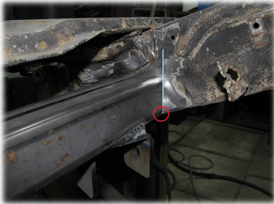
Fot.20 Widok na prawą wewnętrzną stronę ramy. Pokrywająca się powierzchnia tylnej ściany poprzeczki z wytrasowana linią oraz punkt kontrolny w czerwonym kółku.
