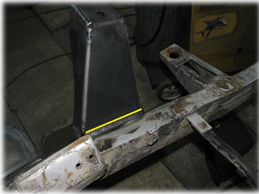
Fot.12 Nieobowiązkowe połączenie spawane górnego uchwyty amortyzatora przedniego możliwe do wykonania na zdemontowanej karoserii
