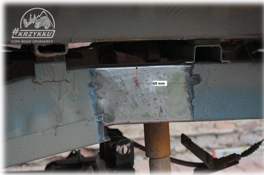
Fot.8 Widok lewego tylnego nadkola, wyznaczanie środka górnego gniazda sprężyny.
