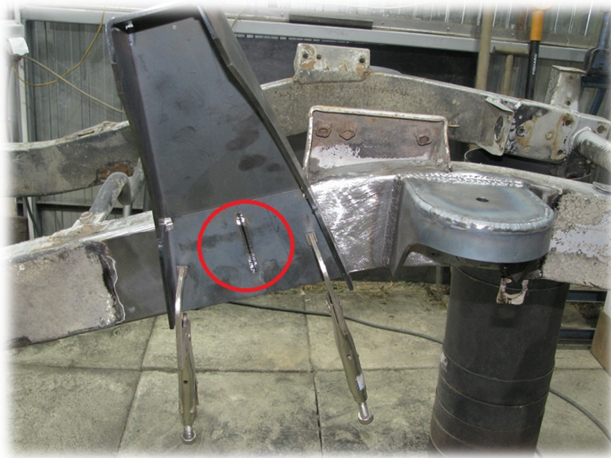
Fot.10 Lokalizacja górnego mocowania amortyzatora przedniego względem wyznaczonej linii
