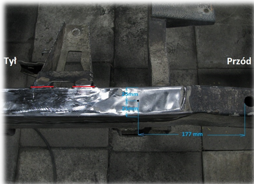
fot.1 Widok od spodu na lewą (strona kierowcy) podłużnicę ramy.
