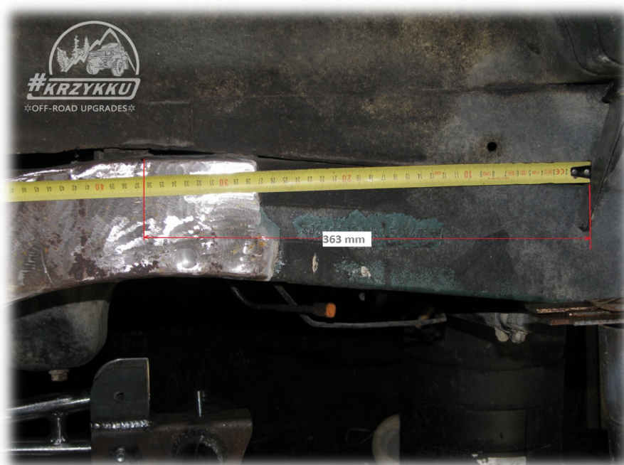
Fot.6 Widok prawego przedniego nadkola, wyznaczanie środka gniazda sprężyny
