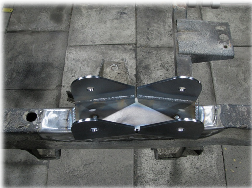
Fot.4 Połączenie spawane podwójnego uchwytu wahaczy
