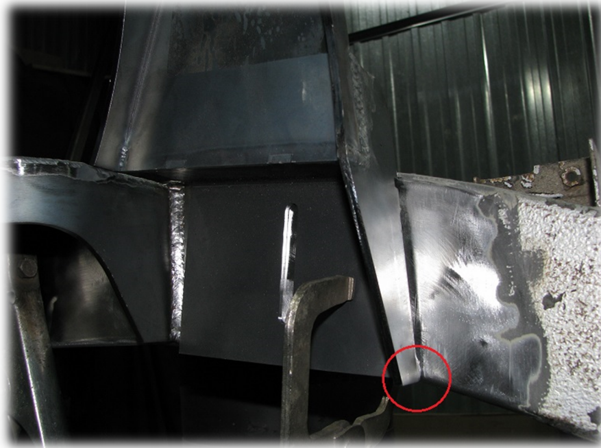
Fot.16 Ustawienie prawej krawędzi górnej mocowania amortyzatora prawego, tylnego
